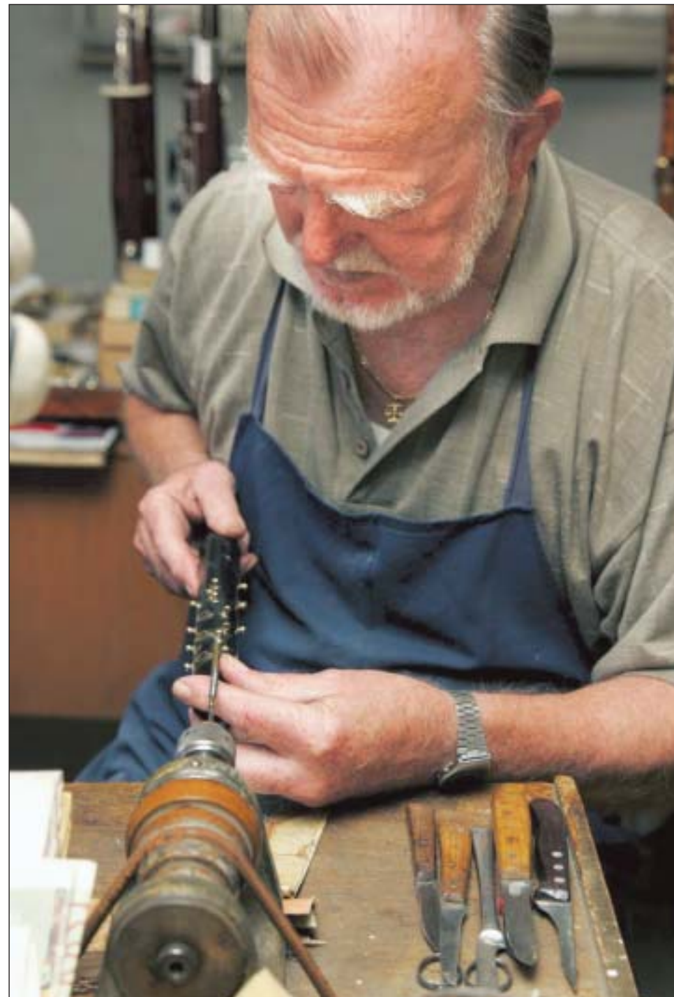
Oben: Josef Pickert bei der Arbeit in seiner Werkstatt. Früher wie heute fertigt er so viel wie möglich selbst an seinen Flöten, Klarinetten und Fagotten. Wenn die Instrumente fertig sind, drückt Pickert ihnen seinen Stempel auf (links): „Pickert Schwaikheim“.
